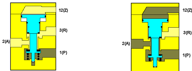
Gambar 3.6a : Katup 3/2 Pilot Tunggal N/C, dalam keadaan tidak aktif Gambar 3.6b : Katup 3/2 Pilot Tunggal N/C, dalam keadaan aktif
