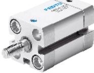
Der Zylinder besitzt einen Anschluss sowie eine Entlüftungsbohrung auf der Stangenseite. Diese muss gegen Verschmutzung gesichert werden, damit die Bewegung des Kolbens nicht durch Luftstau behindert wird. Deshalb wird in der Regel am Entlüftungsausgang ein Filter angebracht.
