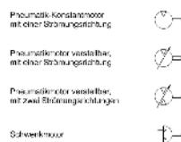
Drehantriebe werden unterteilt in Motoren mit kontinuierlicher Drehbewegung und Schwenkantriebe mit begrenztem Drehwinkel. Druckluftmotoren arbeiten normalerweise in sehr hohen Drehzahlbereichen. Schwenkantriebe haben entweder feste oder einstellbare Drehwinkel.
